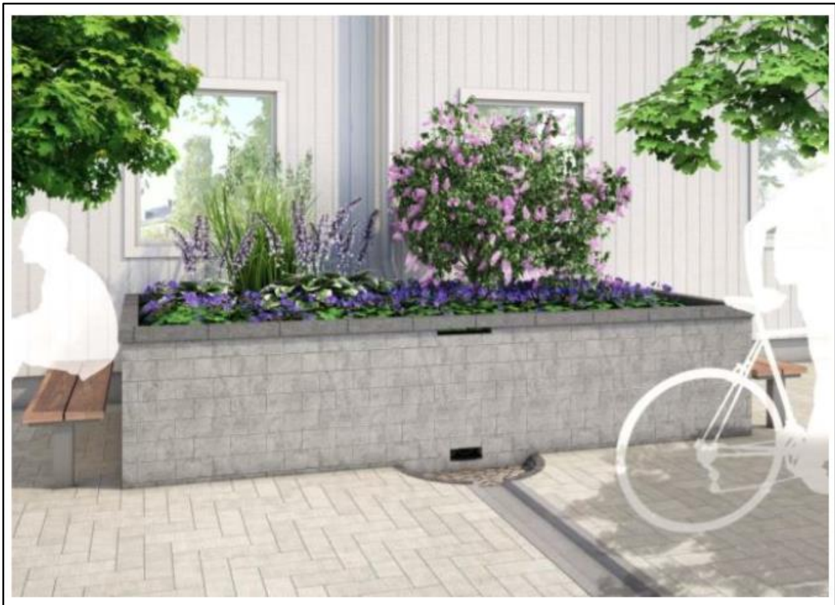
Figur 13, Upphöjt biofilter som tar emot dagvatten från tak via stuprör, med utlopp i botten och avledning via ränna. (Vinnova, 2014)
