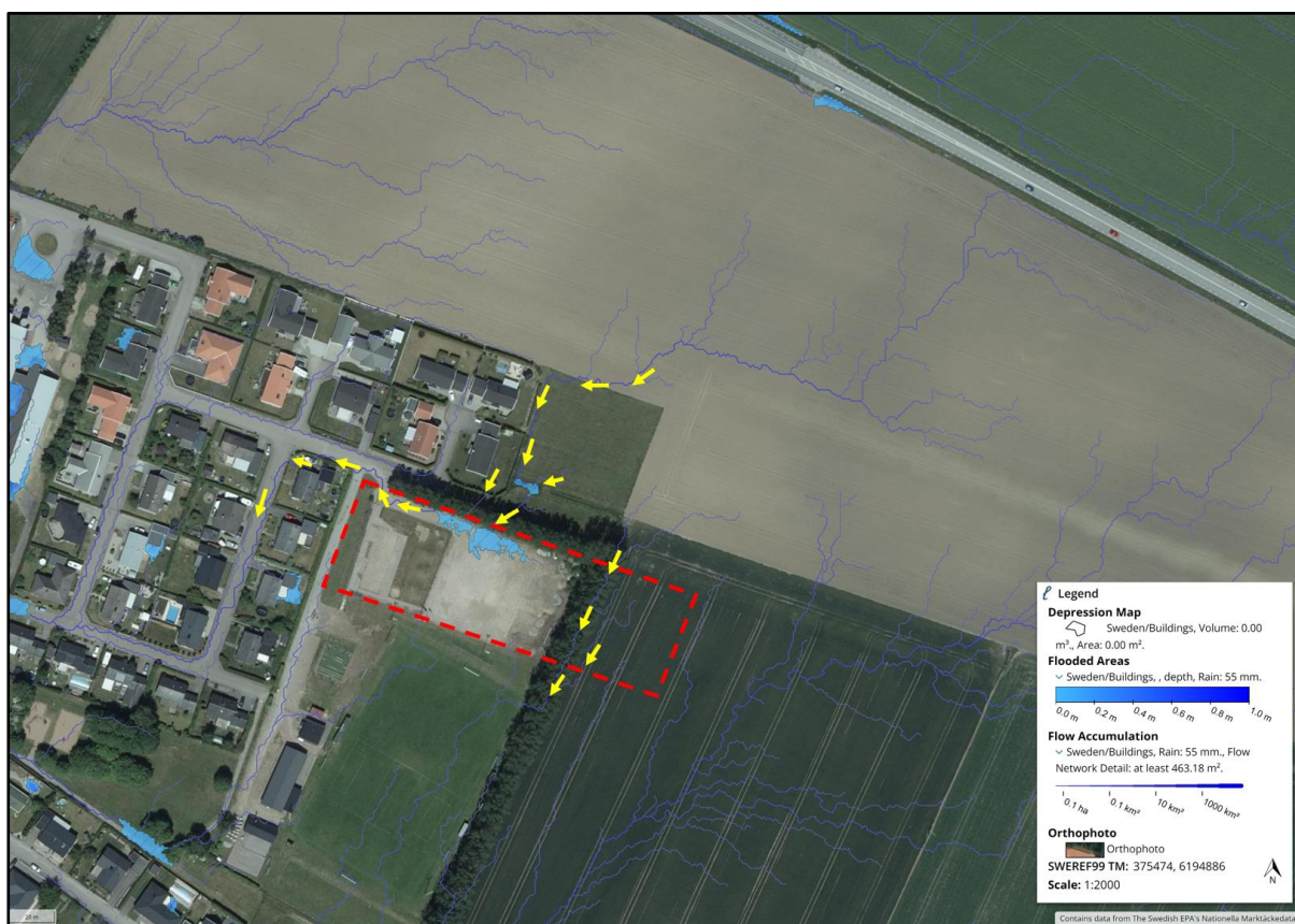
Figur 9, Avrinningsvägar och lågpunkter vid ett 100-årsregn (SCALGO, 2021)
