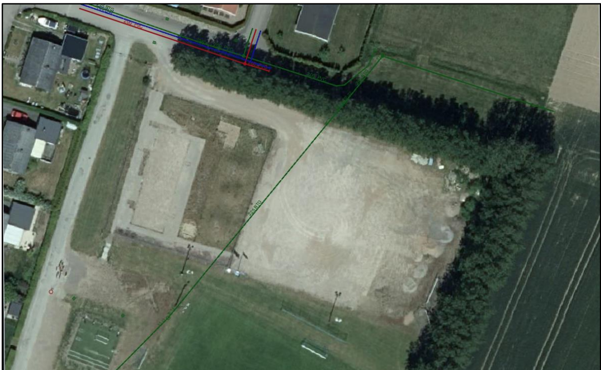
Figur 10, Befintlig dagvattenledning som löper genom planområdet (Norconsult, 2021)
