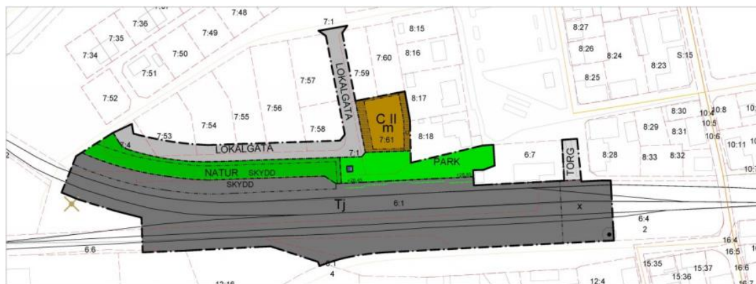
Figur 3. Plankarta för detaljplaneområdet söder om Teckomatorp 7:53 m.fl., som visar planerat skydd utmed järnvägen. Källa: Svalövs kommun.
