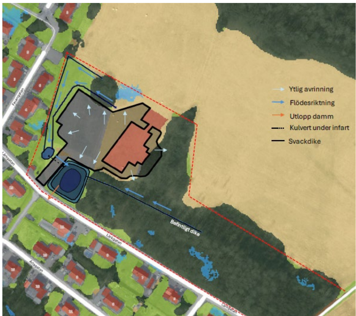
Föreslagen dagvattenlösning (Kodeda, 2024-08-04).
