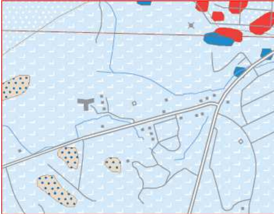
Figur 2. Utklipp från SGU:s jordartskarta. Blå färg, skrafferat med L, representerar lerig morän.
